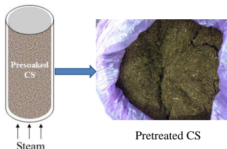
图 1.4 玉米秸秆的干式稀酸预处理过程
